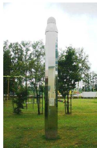
電子基準点：全国に 2000 ヶ所ほどある。衛星からの電波を受信し、誤差の情報を取得し続けている。
